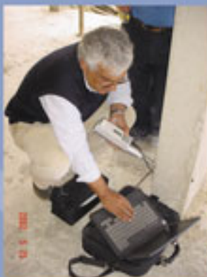
Determinação da resistência do betão "in situ" com esclerómetro electrónico
